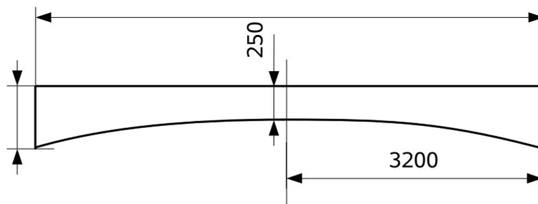
**Les cotes de ce schéma sont en millimètres. La cote 250 indique l'épaisseur minimale.**
